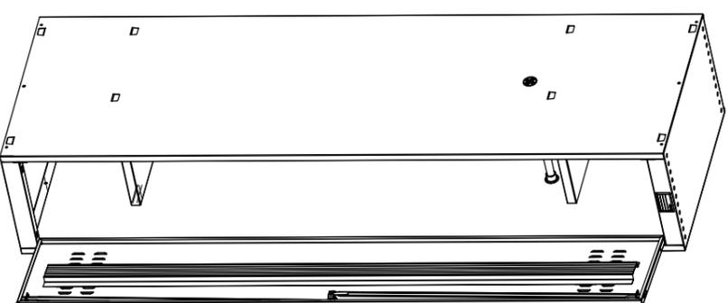
**ВАЖНО!** При наличии вертикального люфта двери, необходимо устранить его, путем подкачивания регулировочной шайбы(входит в комплектацию) под ось.
