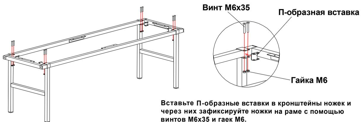
Вставьте П-образные вставки в кронштейны ножек и через них зафиксируйте ножки на раме с помощью винтов М6х35 и гаек М6.
