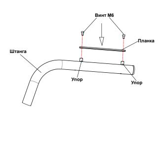
Закрепите штангу с помощью гайки M8 и шайбы 8. Установите ручку между двух упоров и закрепите планку с помощью винтов M6.
